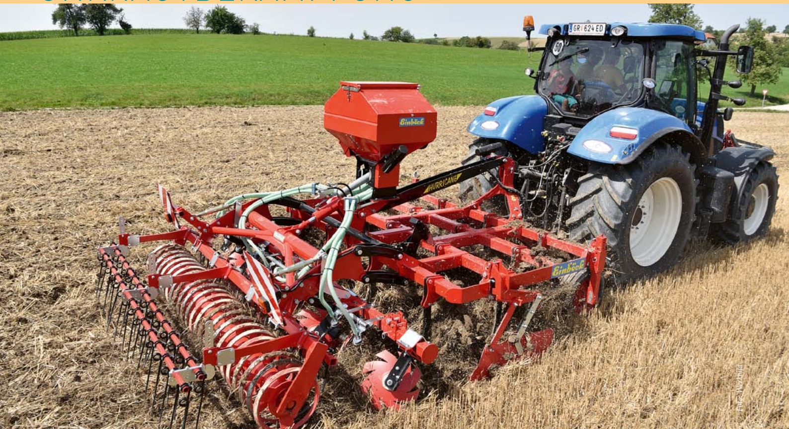
Flache Bodenbearbeitung auf 3–5 cm Tiefe in Verbindung mit der Aussaat von Zwischenfrüchten.
